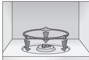
5. Coloque el plato sobre la guía de modo que las tres lenguetas del centro del plato embonen con las del piso del horno.
