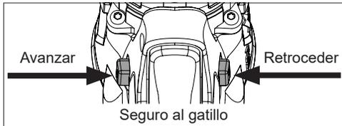
Para **avanzar** (el giro es en el sentido de las manecillas del reloj), se presiona el interruptor de control colocado al lado derecho del taladro. **Verificar la dirección del giro antes de usarlo.**
